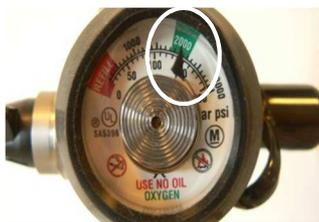
**9.** Durée de remplissage, **environ 2H** sur une bouteille de 1,7L. La bouteille possède une jauge qui vous permet de vérifier son niveau de remplissage. La bouteille est pleine à 2000 Psi (zone verte).
